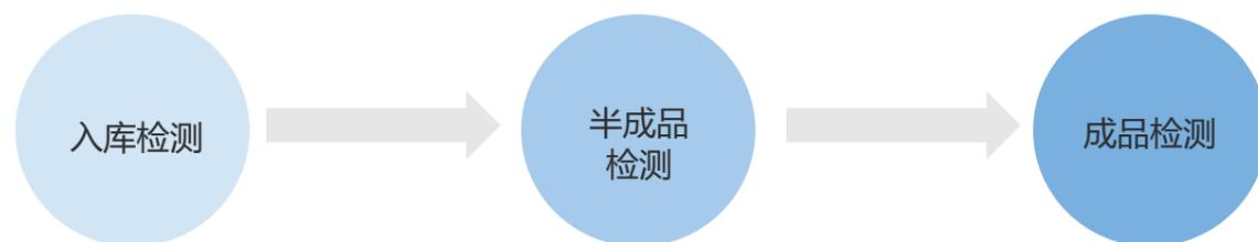
建立原材料验收标准，对原材料水玻璃、硫酸、包材、地台板等进行入库前检测。
